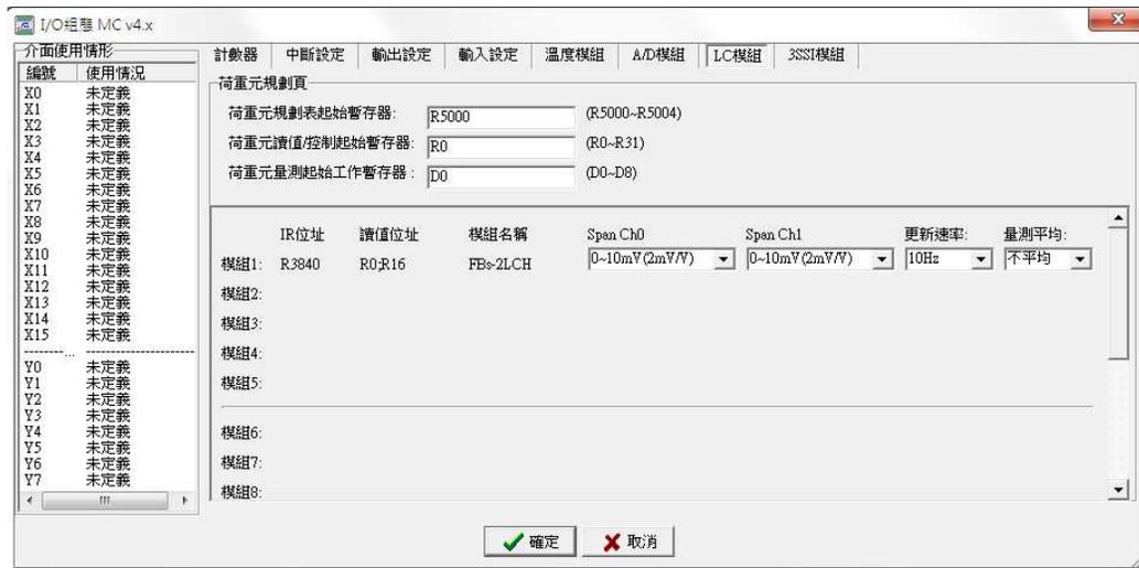
FBs-2LCH模組應用時需搭配 Winproladder 的 I/O 組態設定來進行控制.上圖是 I/O 組態設定中有關荷重元的[LC模組]頁面內容.以下是各欄位的設定說明.
